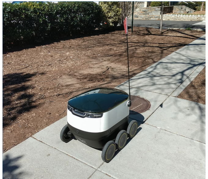
Elektrické robotické vozítko na přepravu zboží, zdroj: http://www.eltis.org/discover/news/new-report-looks-solutions-uk-urban-freight-challenges
